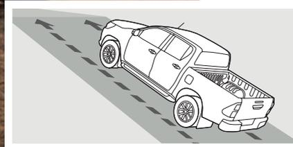
La commande d'assistance au démarrage en côte (HAC) maintient automatiquement la force de freinage jusqu'à deux secondes après le relâchement de la pédale de frein pour vous permettre de démarrer en douceur sans reculer sur des pentes raides.
